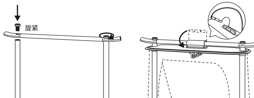
5. 将两边的衣物架锁扣调节到合适的位置, 将衣物架放置在上面, 即可在衣物架上放置内裤或袜子。可根据需求上下移动衣物架锁扣, 从而调整衣物架的位置。
