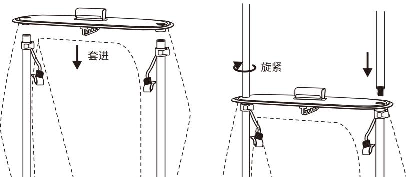
4. 将横杆安装在支撑铝杆顶部, 用横杆螺丝固定好横杆即可。上提衣物护理机盖, 将拉钩套套在横杆上并扣好拉钩套。
