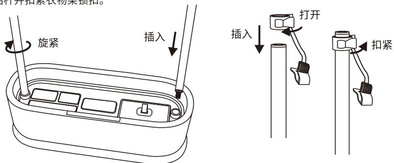
3. 将衣物护理机盖套进主机上两边的支撑铝杆, 然后将另外两根支撑铝杆安装好。
